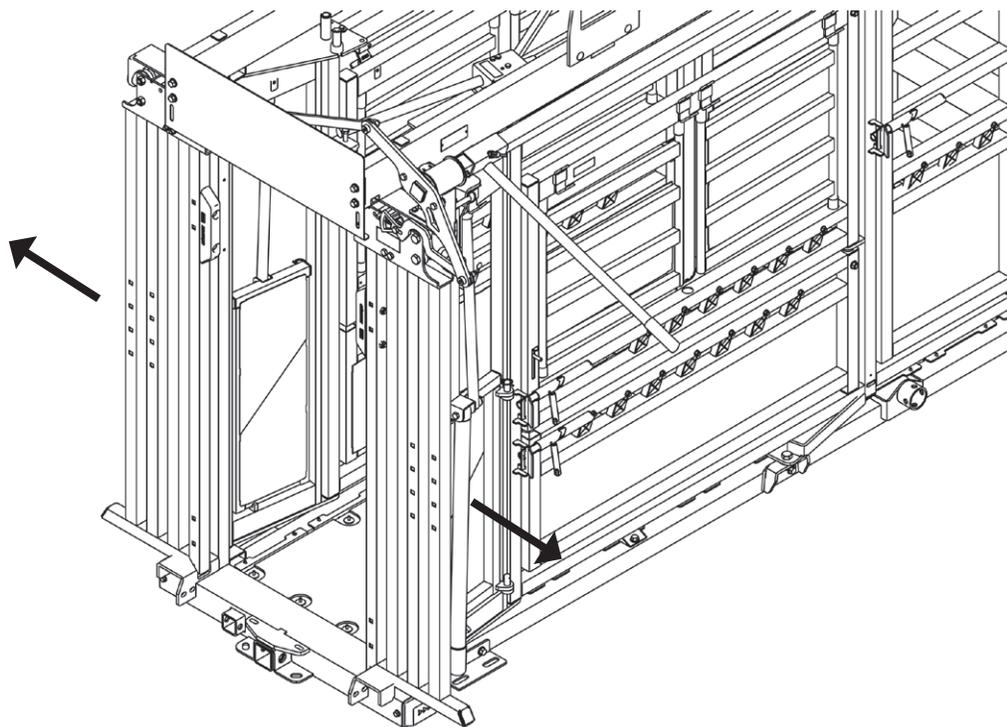
3. Faites glisser la tôle de l'adaptateur de capture des taureaux pour gaucher sur le portillon de la porte de contention en mode pour gaucher.
