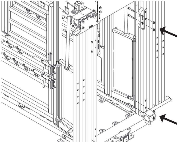
5. Faites glisser la tôle de l'adaptateur de capture des taureaux pour droitier sur le portillon de la porte de contention en mode pour droitier.
