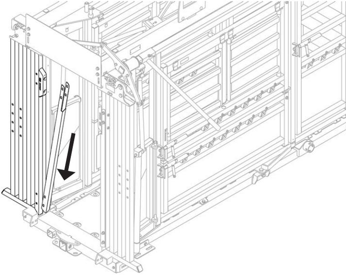
6. Fixez la tôle de l'adaptateur de capture des taureaux pour droitier sur le portillon de la porte de contention à l'aide de quatre (4) boulons de carrosserie et quatre (4) écrous à flasque.
