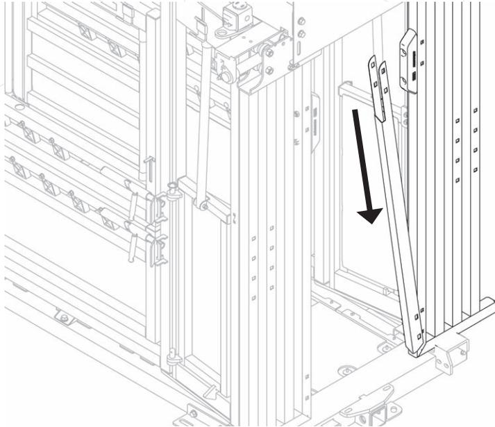
4. Fixez la tôle de l'adaptateur de capture des taureaux pour gaucher sur le portillon de la porte de contention à l'aide de quatre (4) boulons de carrosserie et quatre (4) écrous à flasque.
