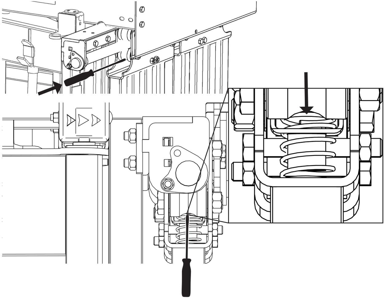
3. Inclinez le pied-de-biche/tournevis vers le haut et dans le rouleau de la porte de contention. Cela poussera le ressort vers le bas, libérant ainsi le mécanisme de verrouillage de la porte de contention.
