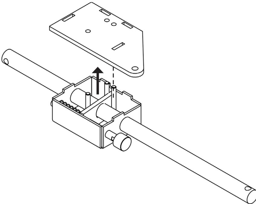
8. Poussez la goupille du système de verrouillage en poussant la plaque de verrouillage vers les deux boulons et retirez l'arbre long du système de verrouillage.
