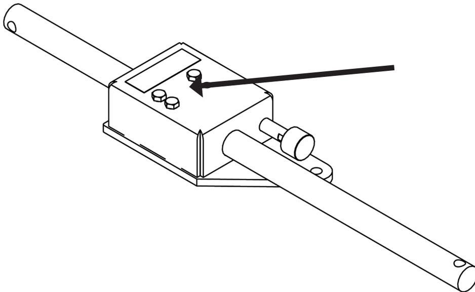
5. Desserrez les trois boulons à l'extérieur du boîtier tout en maintenant les écrous à l'arrière du couvercle du boîtier.
