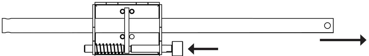
9. Soulevez le boîtier de verrouillage de la surface de travail et retirez le boulon unique situé devant la plaque de verrouillage.
