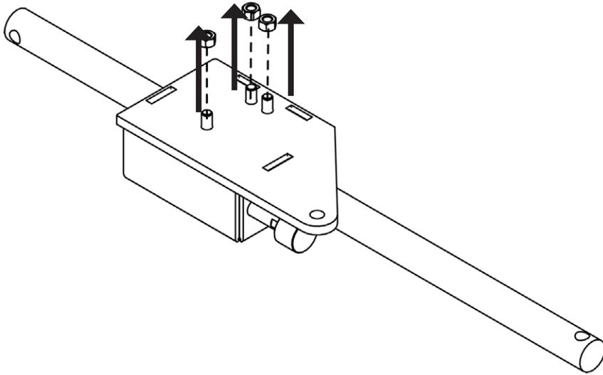
7. Retirez la plaque arrière pour exposer le mécanisme de verrouillage.
