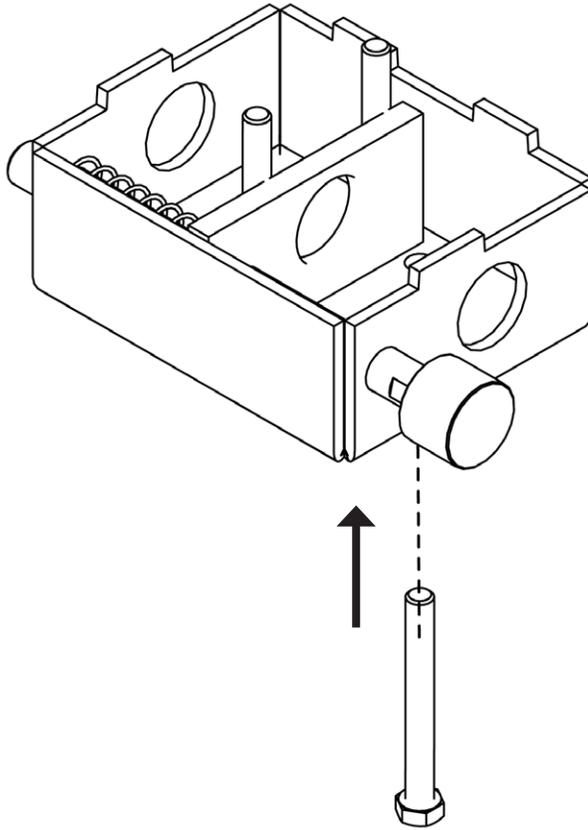
10. Relâchez lentement la pression sur la plaque de verrouillage, puis retirez la plaque de verrouillage, le ressort et le petit arbre du mécanisme.
